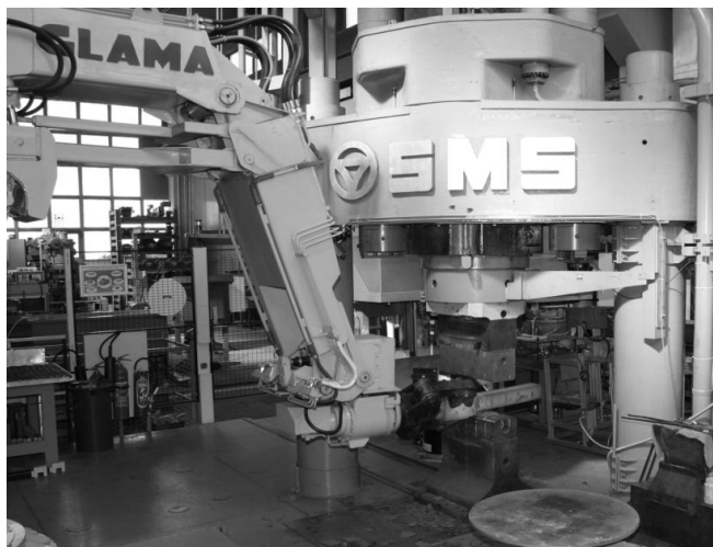
Rys. 7: Wspomagane robotem centrum kucia w IBF [3]
