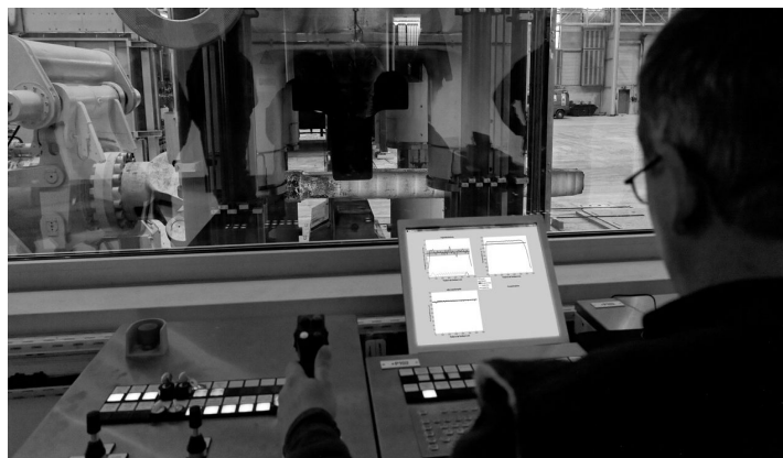
Rys. 3. Modele procesu do szybkiego obliczania online miejscowych i integralnych parametrów podczas kucia [3]
