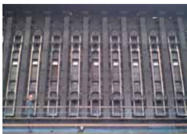
Rys. 6 Zdjęcie i obraz termowizyjny drzwi piecowych na jednej z ocenianych baterii koksowniczych
