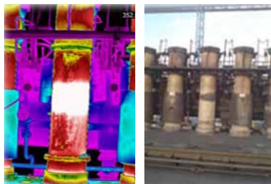
Rys. 3 Zdjęcie i obraz termowizyjny rur odciążowych gazu surowego na jednej z ocenianych baterii koksowniczych
