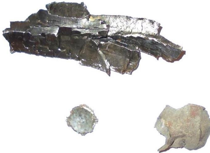
Fot. 1. Odłamki z pocisków nie posiadających wymuszonej fragmentacji. Źródło: opracowanie własne
