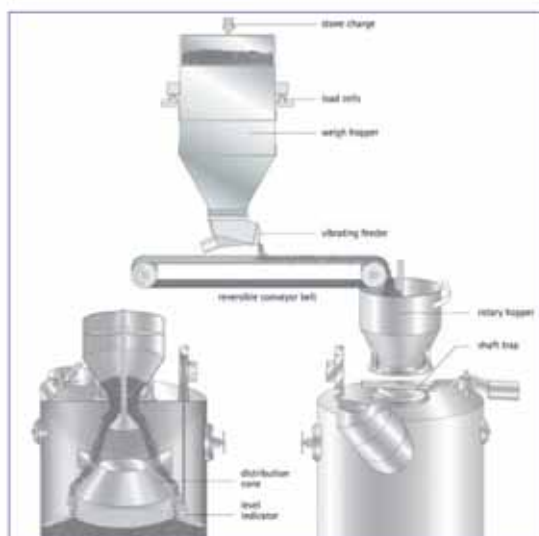
Rys 8 System stosujący skip obrotowy w miejsce załadowczej pochylni, aby uzyskać najlepsze rozmieszczenie kamienia przed załadunkiem go do szybu. Skip jest umieszczony bezpośrednio nad szybem.
