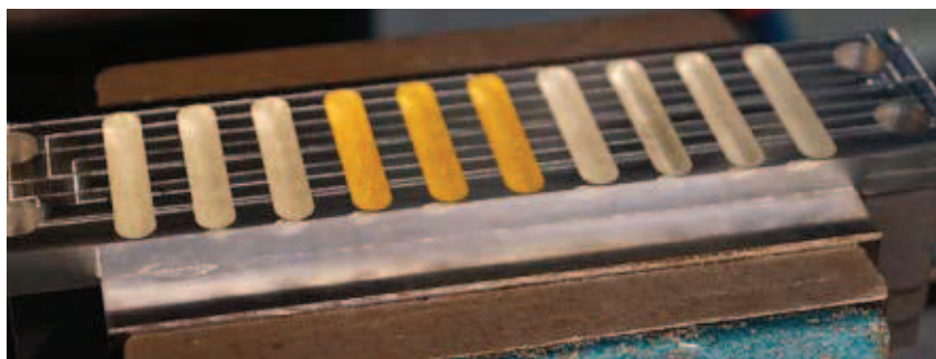
Rys. 1. Widok próbki z wykonanymi rowkami wypełnionymi tworzywem epoksydowym
