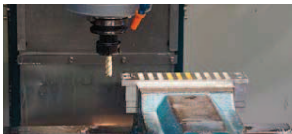
Rys. 2. Widok przygotowanego stanowiska do frezowania próbek: Centrum frezarskie AVIA VMC 800 HS
