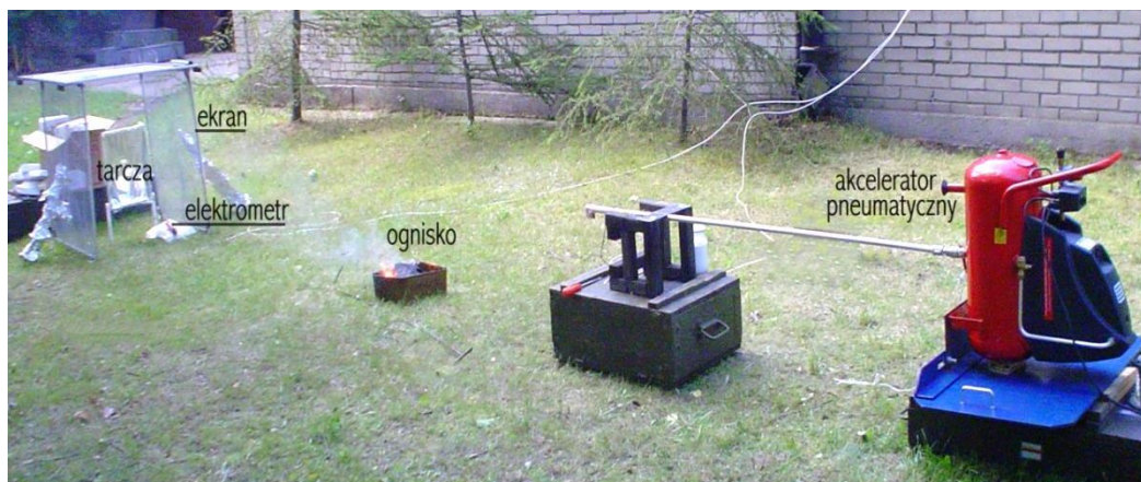
Rys. 10. Widok stanowiska do badań elektryzacji obiektów przelatujących przez dymy
