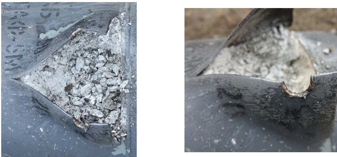
Fot. 7 Widok szczegółowy perforacji i miejscowego rozerwania przedniej części korpusu bomby nr 2 oraz penetracji i rozkruszenia ładunku TNT przez urządzenie EGP typu I (strzał 4): a – widok z góry, b – na pierwszym planie widok krawędzi blachy korpusu bomby z łukowatym fragmentem, świadczącym tym, że najpierw miała miejsce perforacja korpusu w postaci otworu kołowego, a następnie jego rozerwanie.
