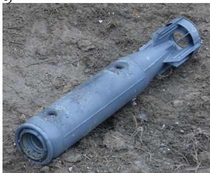
Fot. 9 Badanie konfiguracji: dwa urządzenia EGP typu II – bomba nr 4 (strzał 6): a – widok szczegółowy ustawienia urządzenia EGP typu II naprzeciw ładunku TNT bomby, w odległości 10 mm od jej powierzchni, b- ustawienie obu urządzeń EGP typu II względem bomby, c – efekt oddziaływania dwóch EGP na bombę.
