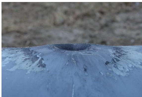
Fot. 10 Widok szczegółowy perforacji tylnej części korpusu bomby nr 4 przez urządzenie EGP z urządzenia EGP typu II (strzał nr 6): a – widok z góry, b – widok z boku.
