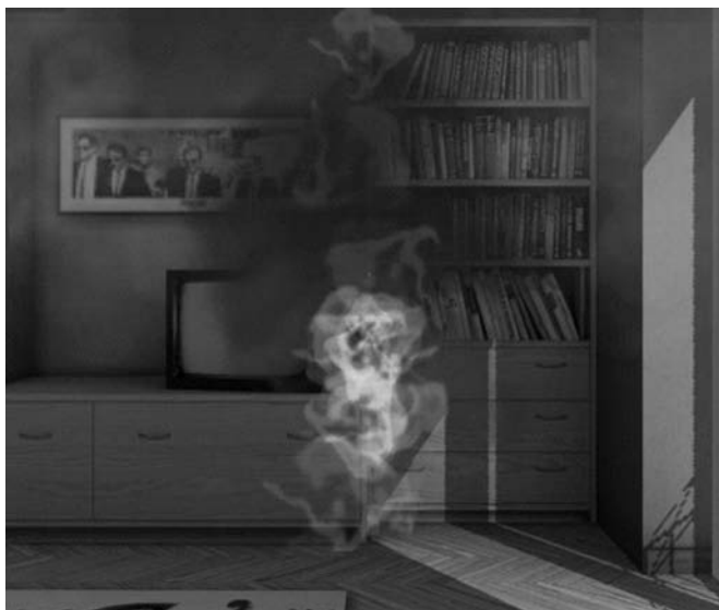
Rys. 3 Widok spalania płomieniowego, po 1 min 30 s
