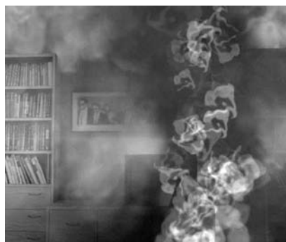
Rys.6. Spalanie płomieniowe, po upływie 2 min 30 s
