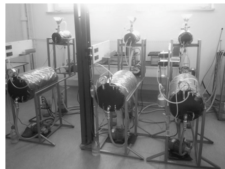
Rys. 2. Reaktory do prowadzenia badań procesu fermentacji metanowej.
