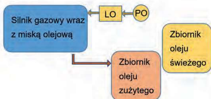
Fig. 1. Simplified diagram of the lubricating oil installation Rys. 1. Schemat uproszczony instalacji oleju smarnego
