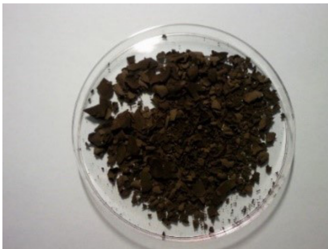
Rys. 8. Biowęgiel z biomasy mikroalg Chlorella sp.
