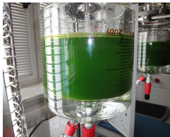
Rys. 2. Laboratoryjny bioreaktor do produkcji biomasy alg – zakończenie hodowli
