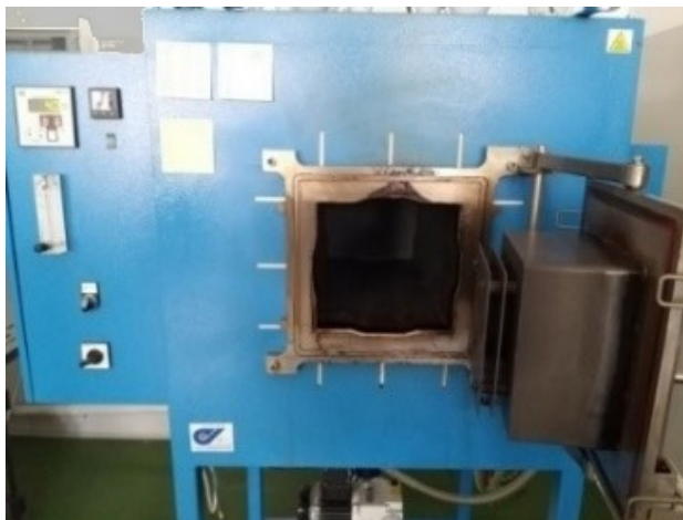
Rys. 4. Piec do prowadzenia procesu pirolizy
