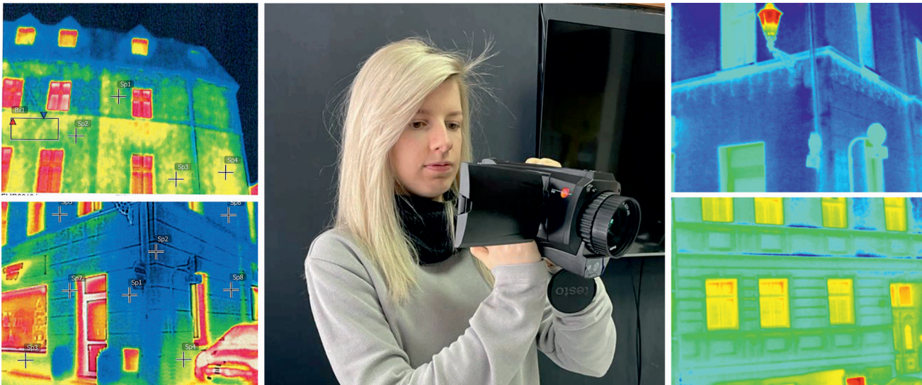
Fot. 4. Badania termowizyjne powykonawcze z 2021 roku (mgr inż. Natalia Jaworska, ML-BUD). Przygotowanie kamery termowizyjnej do ponownych badań kontrolnych po kilku latach użytkowania obiektów w 2022 roku (mgr inż. Roxana Fross). Kamera termowizyjna na wyposażeniu Pracowni Badań Jakości Środowiska Zbudowanego Katedry RA5 Wydziału Architektury Politechniki Śląskiej; źródło: fot. K. Fross, 2022
