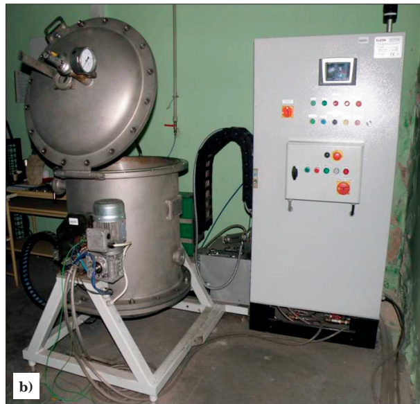
Rys. 13. Urządzenia wytapiające wykorzystane do prób wytapiania stali z renem: a) otwarty piec indukcyjny, b) próżniowy piec indukcyjny o pojemności do 5 kg ciekłej stali
