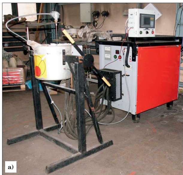
Rys. 13. Urządzenia wytapiające wykorzystane do prób wytapiania stali z renem: a) otwarty piec indukcyjny, b) próżniowy piec indukcyjny o pojemności do 5 kg ciekłej stali
