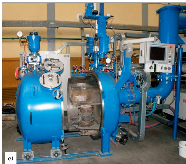
Rys. 13 cd. Urządzenia wytapiające wykorzystane do prób wytapiania stali z renem: c) próżniowy piec indukcyjny VIMLab 30 o pojemności do 30 kg ciekłej stali
