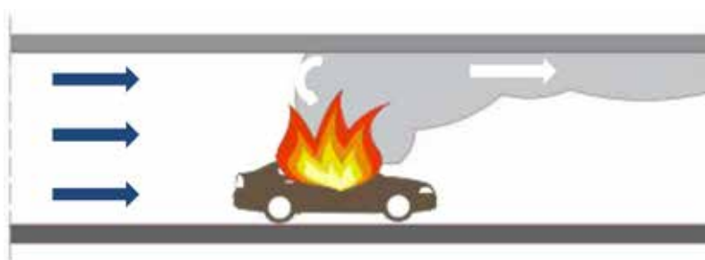
Rycina 3. Przemieszczanie się warstwy dymu przy prędkościach powyżej 3 m/s [1]
