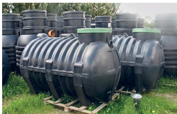
Rys. 7. Zbiorniki wyprodukowane metodą odlewania rotacyjnego [źródło własne]
