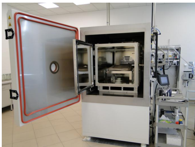
Rys. 1. Szczelna komora WKE 1000 do badań emisji LZO wraz z akcesoriami do pobierania próbek i detektorem FID
