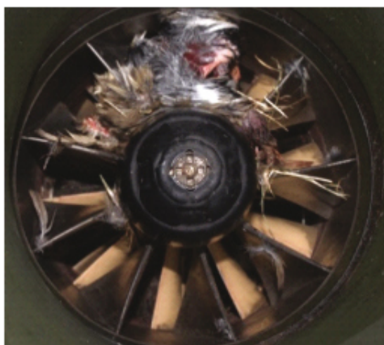
Rys. 6. Uszkodzenie sprężarki silnika odrzutowego [8].
