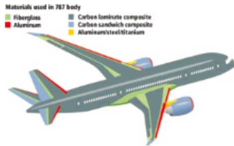
Rys. 3a. Materiały użyte w konstrukcji Boeinga 787 [5].
