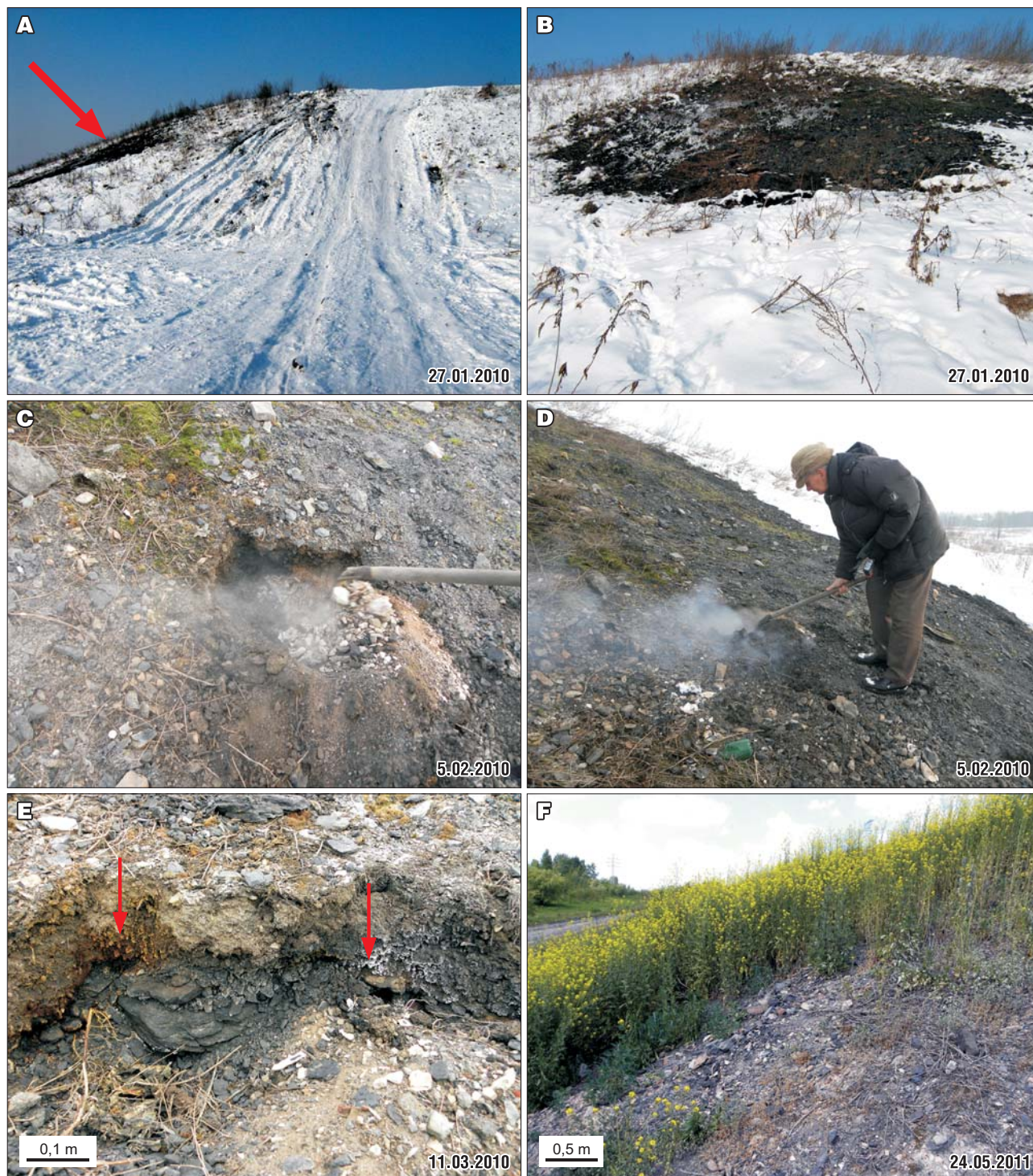
Ryc. 5. Skarpa południowo-zachodnia: A – nowo powstałe pole 50 o średnicy ok. 15 m (wskazane strzałką); B – szadź oraz para wodna w lewej części pola 50; C – przepalony pomarańczowo-różowy okruchy skał; D – zapożarowanie dolnej części pola 50. Na głębokości 30 cm temperatura wynosiła 460°C; E – wykwitki siarki (żółte) oraz salmiaku (białe) u ujścia szczelin ekshalacyjnych; F – bujna roślinność rosnąca wokół pola 50. Ryc. 5A–F fot. J. Ciesielczuk
