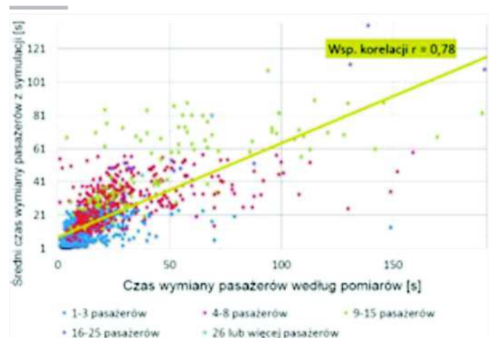
Rys. 5. Zależność pomiędzy czasem wymiany pasażerów z pomiarów a uśrednionym czasem z symulacji: a) autobusy przewoźnika miejskiego, b) pojazdy pozostałych użytkowników
