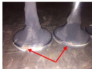
Rys.34. Widok miejscowego nadpalenia / wykruszenia grzybka zaworu dolotowego.
