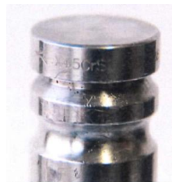
Rys.18 Widok zaworów dostarczonych do badania Rys.19 Obraz zarysowanej górnej części trzonka zaworu
