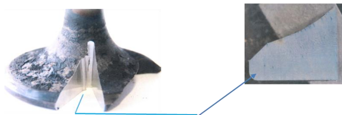
Rys. 26. Widok grzybka zaworu dolotowego z wycinkiem-grzybka zaworu do badań metalograficznych
