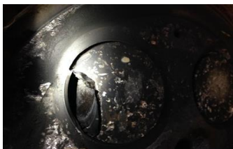
Rys.1 Obraz uszkodzonego zaworu dolotowego.
