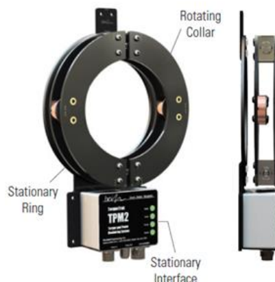
Na rys.13, Widok torsjometru użytego do pomiaru momentu obrotowego przenoszonego przez wał śrubowy
