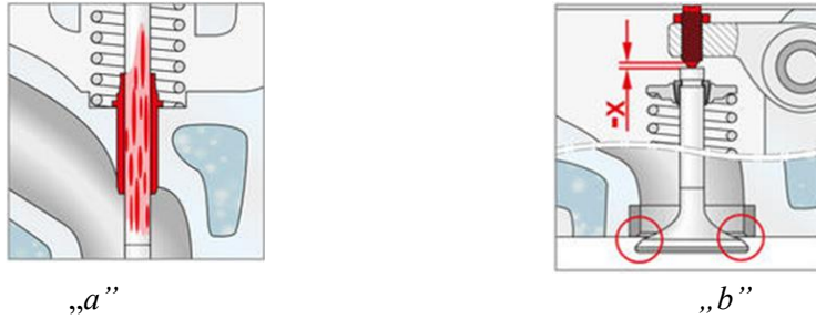
Rys.32 Widok miejscowych uszkodzeń zaworów: a – trzonka a powodu zbyt małego luzu w prowadnicy, b – przylgni zaworu z powodu zbyt małego luzu „x” [11]
