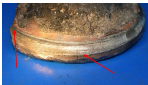
Rys.20. Widok pęknięcia grzybka zaworu oraz brzegu rozdziału brakującego fragmentu zaworu.
