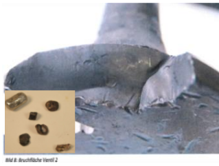
Rys. 23 Obraz uszkodzenia grzybka zaworu dolotowego wskutek kontaktu metalicznego z fragmentami oderwanymi od zaworu, widoczne na małym zdjęciu.
