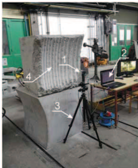
Rys.2. Stanowisko do pomiaru geometrii skrawów w laboratorium Instytutu Mechanizacji Górnictwa: 1 – skaner laserowy, 2 – stanowisko komputerowe, 3 – statyw, 4 – obiekt badań (blok cementowo-piaskowy z wykonaną serią skrawów)
