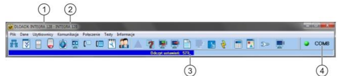
Rys. 30. Menu programu DLOADX: 1. Model centrali alarmowej; 2. Nazwa systemu/pliku z danymi; 3. Pasek zapisu/odczytu danych; 4. Informacja o stanie komunikacji [5]
