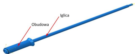
Rys. 4. Model geometryczny wtryskiwacza założony do badań symulacyjnych
