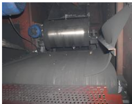
Rys. 3.2 Przemysłowa linia przerobu akumulatorów - separator elektrodynamiczny
