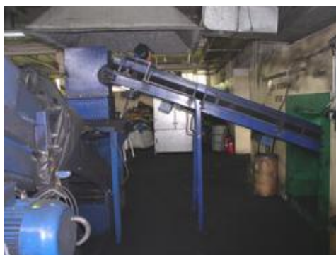
Rys. 3.1 Przemysłowa linia przerobu akumulatorów - rozdrabniacz
