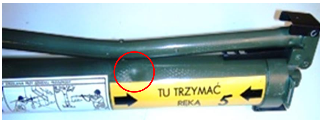
Fot. 14. Wgniecenie w ścianie wyrzutni granatnika RPG-76 Photo 14. A bending in the wall of RPG-76 grenade launcher
