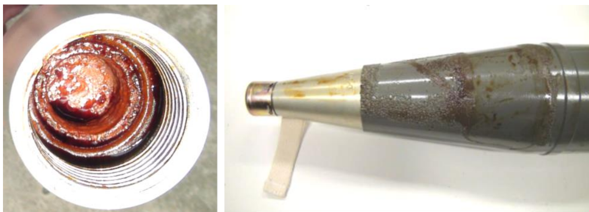
Fot. 9. Olej trotylowy na powierzchni MW (a) i na zewnętrznej powierzchni pocisku OG-9 (b) Photo 9. Trotyl oil on the surface of explosive material (EM) (a) and outside of OG-9 projectile (b)
