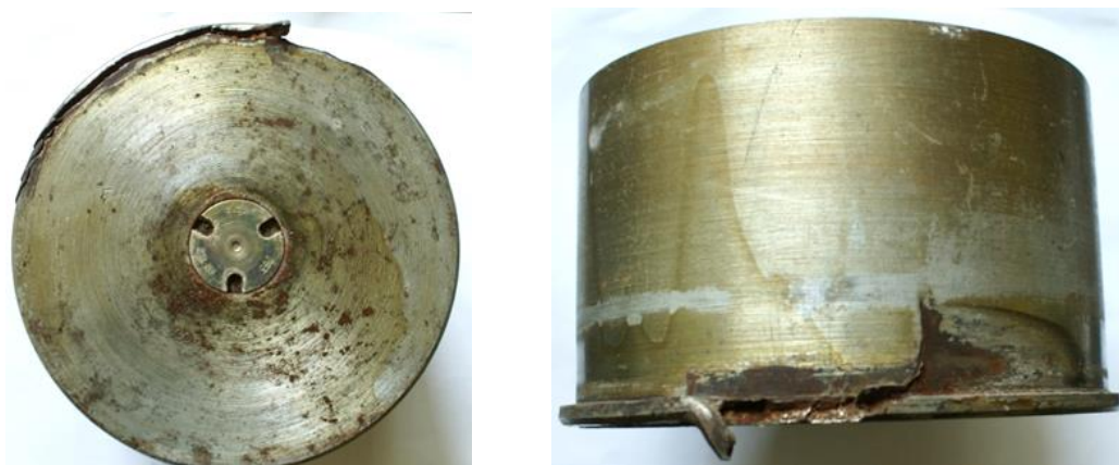
Fot. 11. Przerwanie ścianki bocznej 100 mm łuski stalowej przez gazy prochowe a – widok od strony zapłonika, b – widok z boku Photo 11. A breaking through the side wall of 100 mm steel case by powder gases a – a view from the side of igniter, b – a side view
