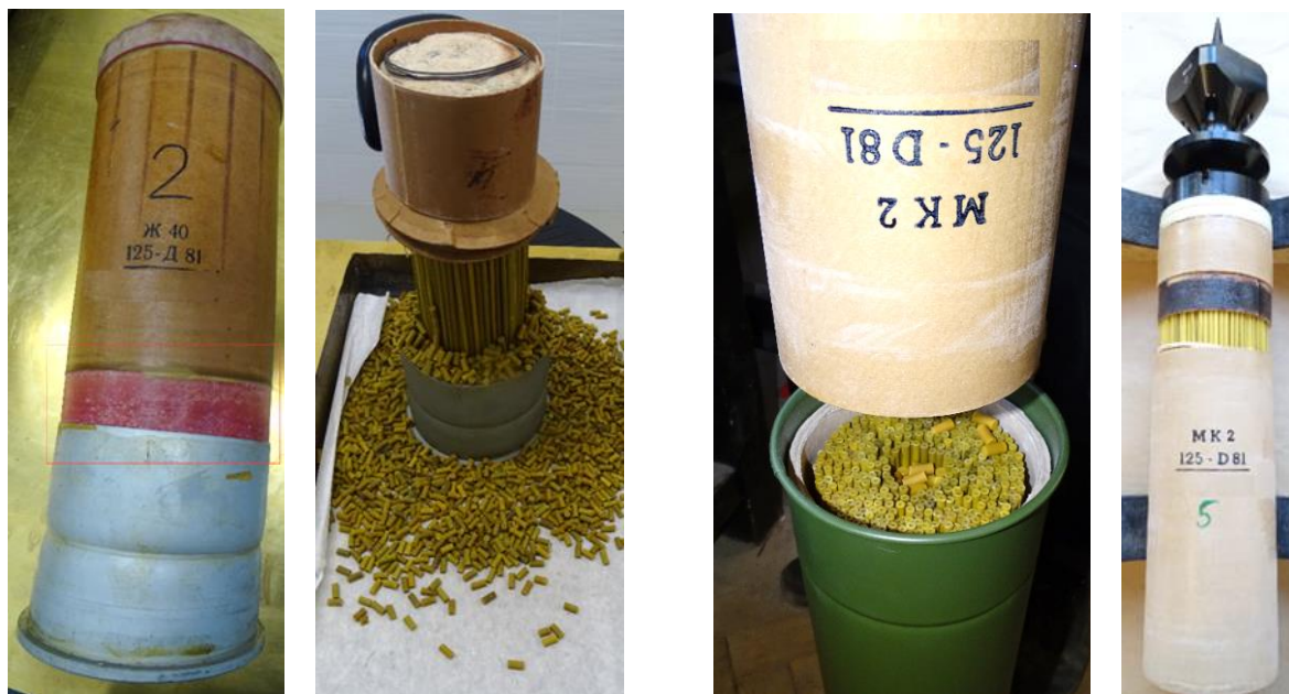
Fot. 7. Odklejony metalowy kadłub okucia od kadłuba łuski spalającej się w ładunku zasadniczym do 125 mm naboju
