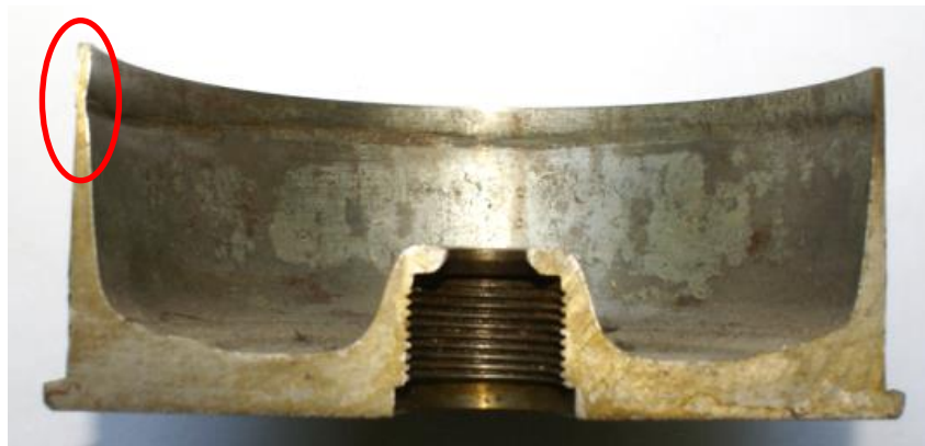
Fot. 10. Przewężenie ścianki 100 mm łuski stalowej w jej dolnej części Photo 10. A narrowing of 100 mm steel case at bottom part
