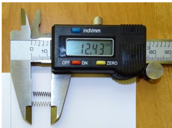
Fot. 3. Sprężyny z zespołu samolikwidatora – górna jest krótsza
