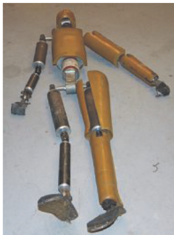
Ryc. 11. Budowa manekina USI Žilina Dummy [15].
