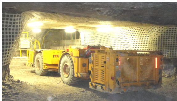
Rys. 9. Samojezdny wóz strzelniczy WS-172 podczas prób eksploatacyjnych w podziemiach kopalni rudy miedzi – ładowanie baterii [2]
