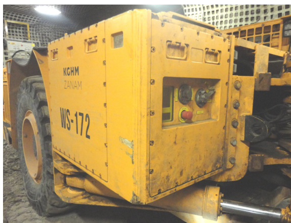
Rys. 2. Moduł baterii zabudowany na wozie strzelniczym [2]
