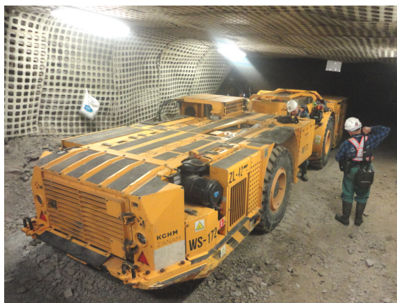
Rys. 8. Samojezdny wóz strzelniczy WS-172 podczas prób eksploatacyjnych w podziemiach kopalni rudy miedzi [2]
