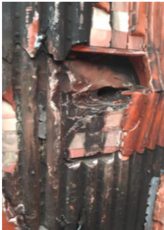
Rys. 3. Widok krateru eksplozywnego uzwojenia SN (fot. serwisu producenta)
