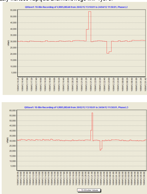
Rys.8. Przepięcia i zapady napięcia zarejestrowane w linii zasilającej stalownię
