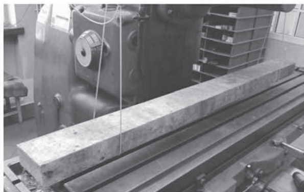
Rys. 3. Widok profili: stalowego niewypełnionego, stalowego wypełnionego polimerobetonem i polimerobetonowego (a) oraz widok swobodnego, poziomego zawieszenia odlewu z polimerobetonu (b)
