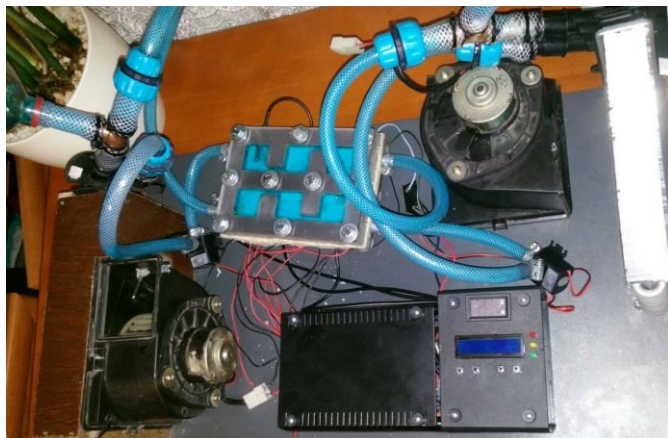
Rys. 12. Zmontowany klimatyzator samochodowy na ogniwach Peltiera
