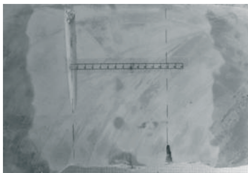
Rys. 6. Strefa hydrofobizowanej opoki przy tłoczeniu preparatu dwoma otworami w rozstawie 12 cm.
