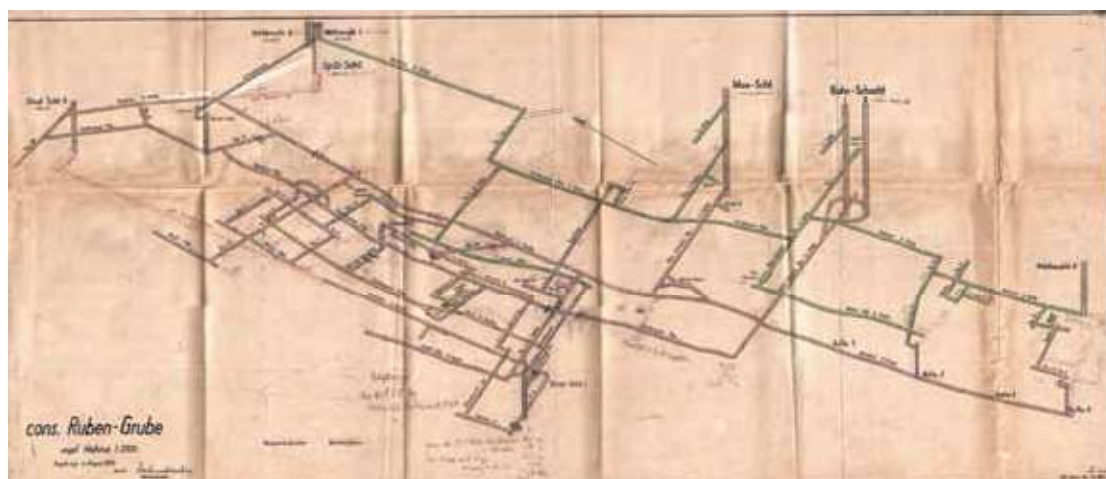
Rys. 11. Schemat przestrzenny wentylacji kopalni „Ruben” zamieszczony w sprawozdaniu dotyczącym zagrożenia wyrzutu gazów i skał. Na schemacie uwzględniono niezbędną przebudowę (Archiwum...)
