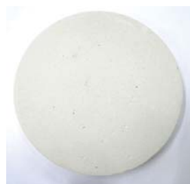
Rys. 4.(a) Próbka 1 - wykonana z czystego gipsu budowlanego, (b) Próbka 1a - z dodatkiem 10% materiału zmiennofazowego
