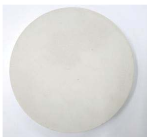
Rys. 4.(a) Próbka 1 - wykonana z czystego gipsu budowlanego, (b) Próbka 1a - z dodatkiem 10% materiału zmiennofazowego
