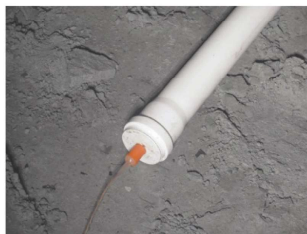
Rys. 3. Sposób montażu sondy pomiarowej w ładunku MW (z lewej) oraz jego widok (z prawej) Fig. 3. Scheme of installation of the ProbeRod in explosive sample (left) and the sample prior to firing (right)
