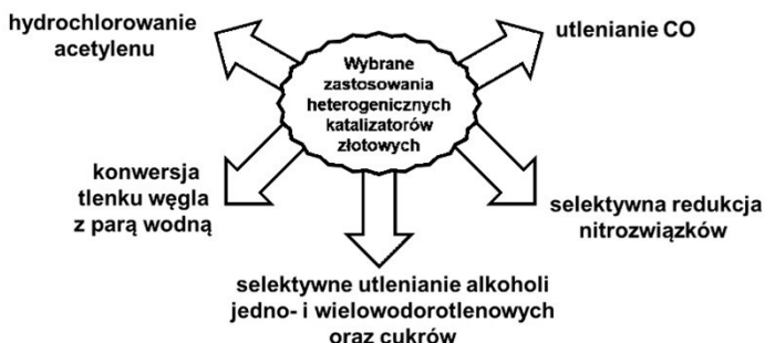
Rysunek 5. Przykłady zastosowań heterogenicznych katalizatorów złotych opisanych w literaturze Figure 5. Examples of heterogeneous gold catalysts applications described in literature
