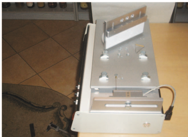
Rysunek 2 Urządzenie do pomiaru adhezji pod kątem 180° w pozycji horyzontalnej z przesuniętą do przodu płytką tylną
