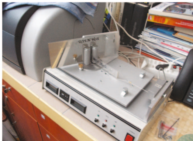
Rysunek 4 Urządzenie do pomiaru adhezji pod kątem 180° w pozycji horyzontalnej z przystawką
