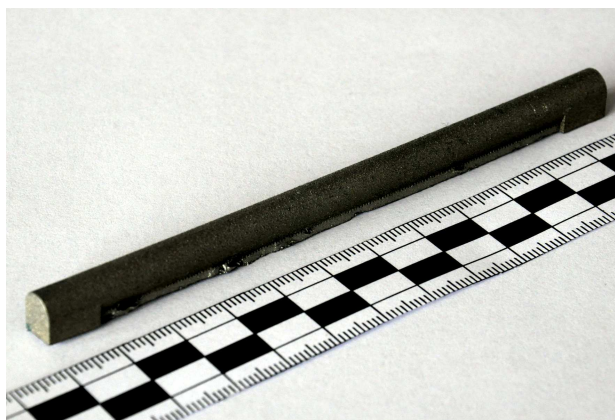
Rys. 4. Próbką wykonaną w technologii DMLS ze stali nierdzewnej 316L
