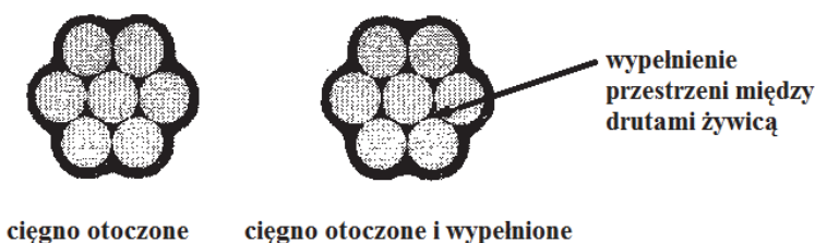
Rys. 13. Zabezpieczenie splotów za pomocą żywicy epoksydowej [1]
