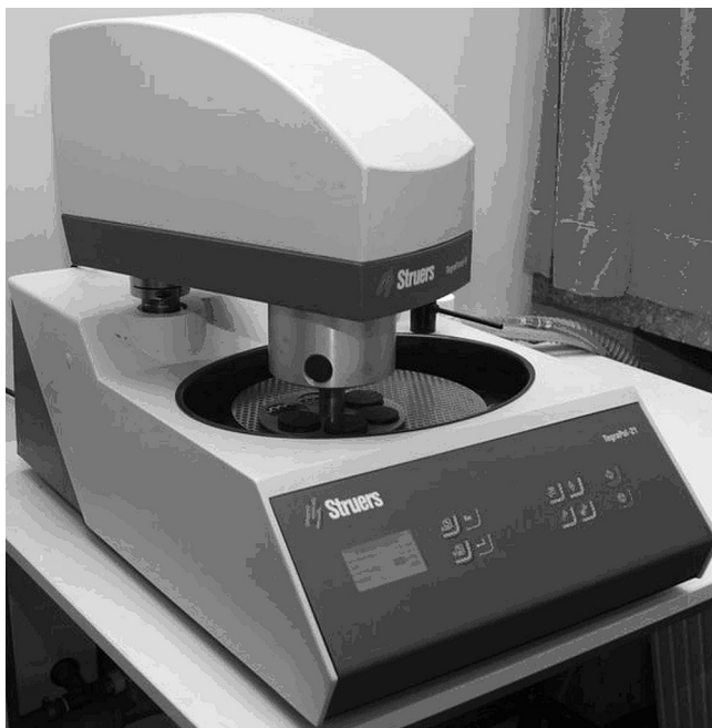
Rys. 2. Struers Tegra Pol 35 urządzenie do szlifowania i polerowania próbek, VŠB-TU Ostrava (Czechy) [11] Fig. 2. Struers Tegra Pol 35 machine for grinding and polishing of samples, VSB-TU Ostrava (Czech Republic) [11]
