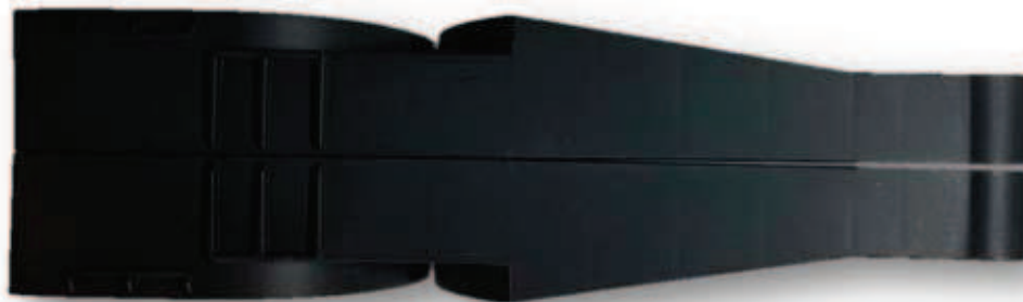
Rys. 1. Zdjęcia wypraski przed optymalizacją kształtu – widoczna deformacja przystających do siebie dwóch wyprasek Fig. 1. View of moldings before shape optimization – visible deformation of moldings
