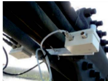
Rys. 4. Czujniki emisji akustycznej (AE) zainstalowane na kablu podwieszającym: a) czujnik z przewodem; b) czujnik bezprzewodowy [2]
