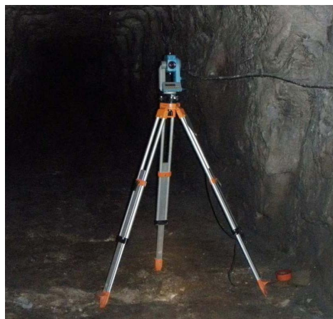
Rys. 13. Pomiar długości bazy tachimetrem
