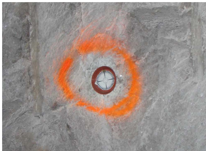
Rys. 7. Tarcza sygnalizacyjna zamocowana na caliznie solnej
