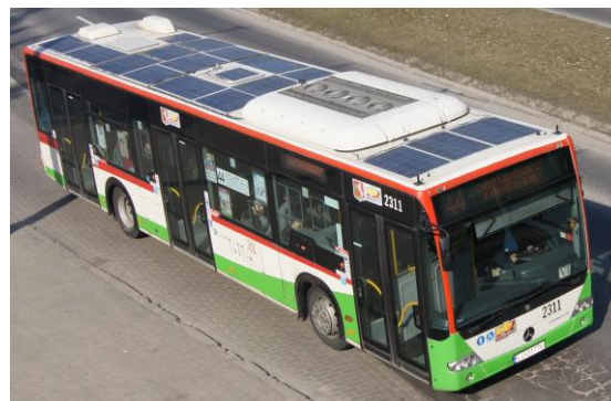
Rys. 2. System fotowoltaiczny zamontowany na dachu Mercedes Connecto 12LF nr 2311.
