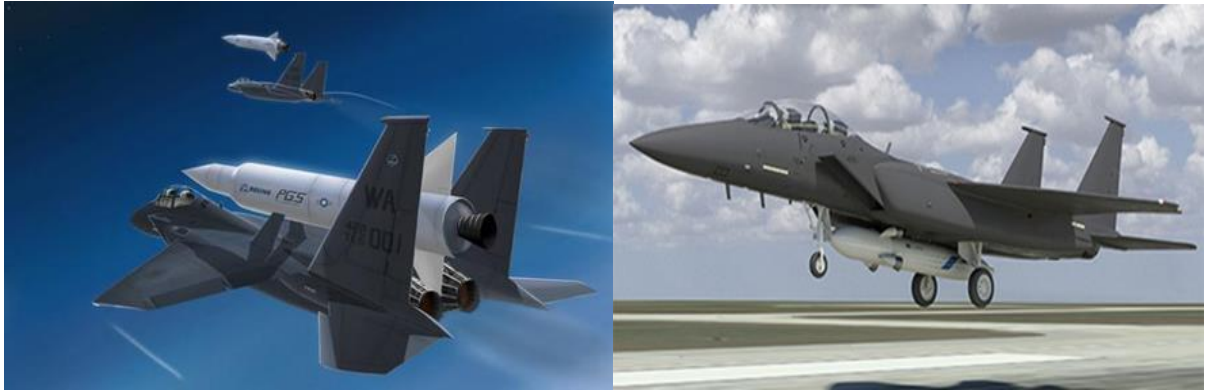
Rys. 2. Ewolucja konfiguracji zestawów lotniczo-rakietowych firmy Boeing, z lewej: F-15 Global Strike Eagle z rakieta na kadłubie, z prawej: F-15E ALASA z rakieta pod kadłubem
