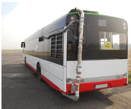
Rys. 1. Widok autobusu miejskiego podczas badań energochłonności układu klimatyzacji
