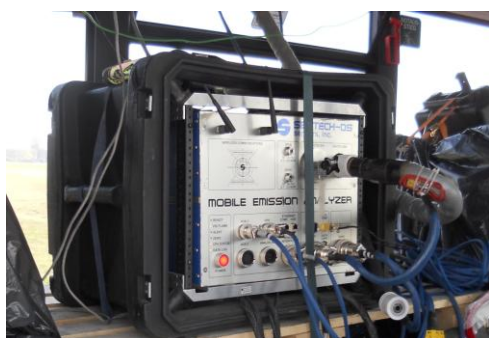
Rys. 3. Widok mobilnego przyrządu SEMTECH DS w trakcie badań
