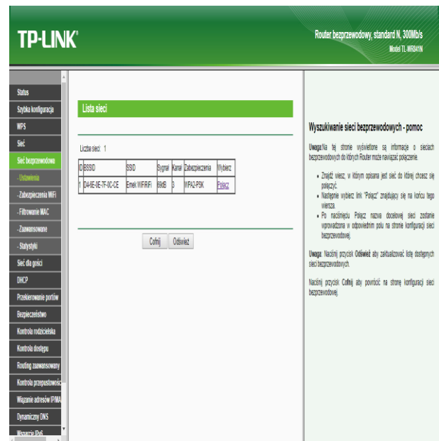
Rys. 9. Opcja "Wykryj" podczas wyszukiwania sieci docelowej – konfiguracja WDS [źródło własne]
