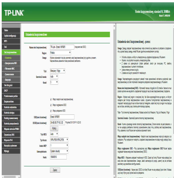
Rys. 10. „Ustawienia bezprzewodowe” po skonfigurowaniu WDS [źródło własne]
