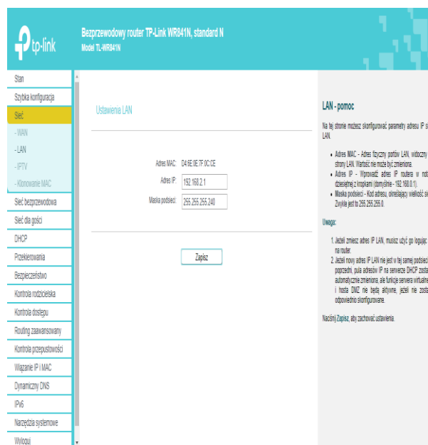
Rys. 1. Ustawienie adresacji routera w sieci LAN [źródło własne]
