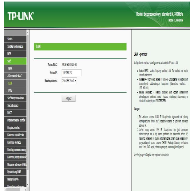
Rys. 8. Konfiguracja LAN na drugim routerze [źródło własne]
