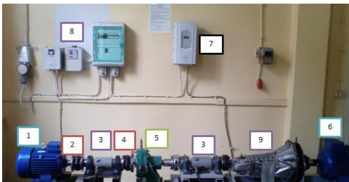
Rys. 5. Stanowisko do badania trwałości zmęczeniowej zazębienia obiegowej przekładni cykloidalnej
