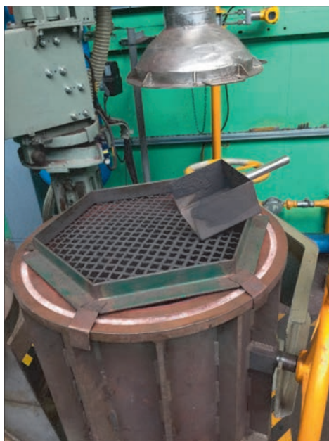
Rys. 6. Misa spiekalnicza z narzędziem do ręcznego ładowania mieszanki
