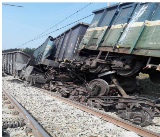
Fot.4. Wykolejony na linii 132 skład pociągowy z fot.1-3 na skutek awarii zestawu kołowego wagonu [źródło: materiały własne]
